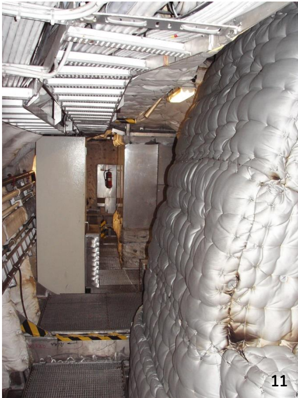
Isolatieleden rondom het uitlaat kanaal
